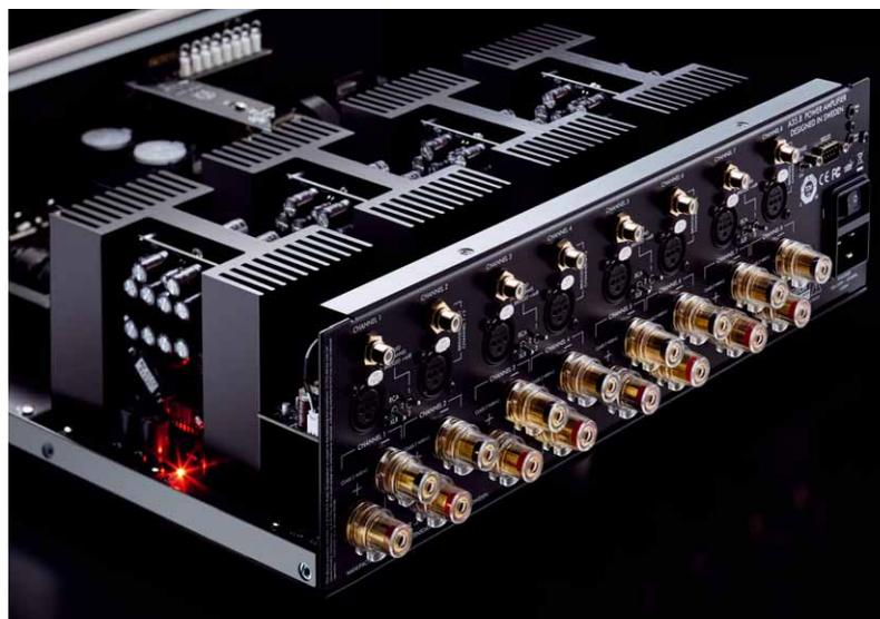
Die Endstufe kann wahlweise per XLR oder Cinch angesteuert werden
