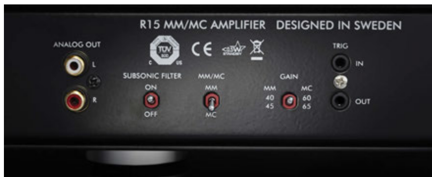
Figura 4 - Dettaglio relativo ai selettori del tipo di testina utilizzato, del guadagno e inserimento del filtro subsonico.
