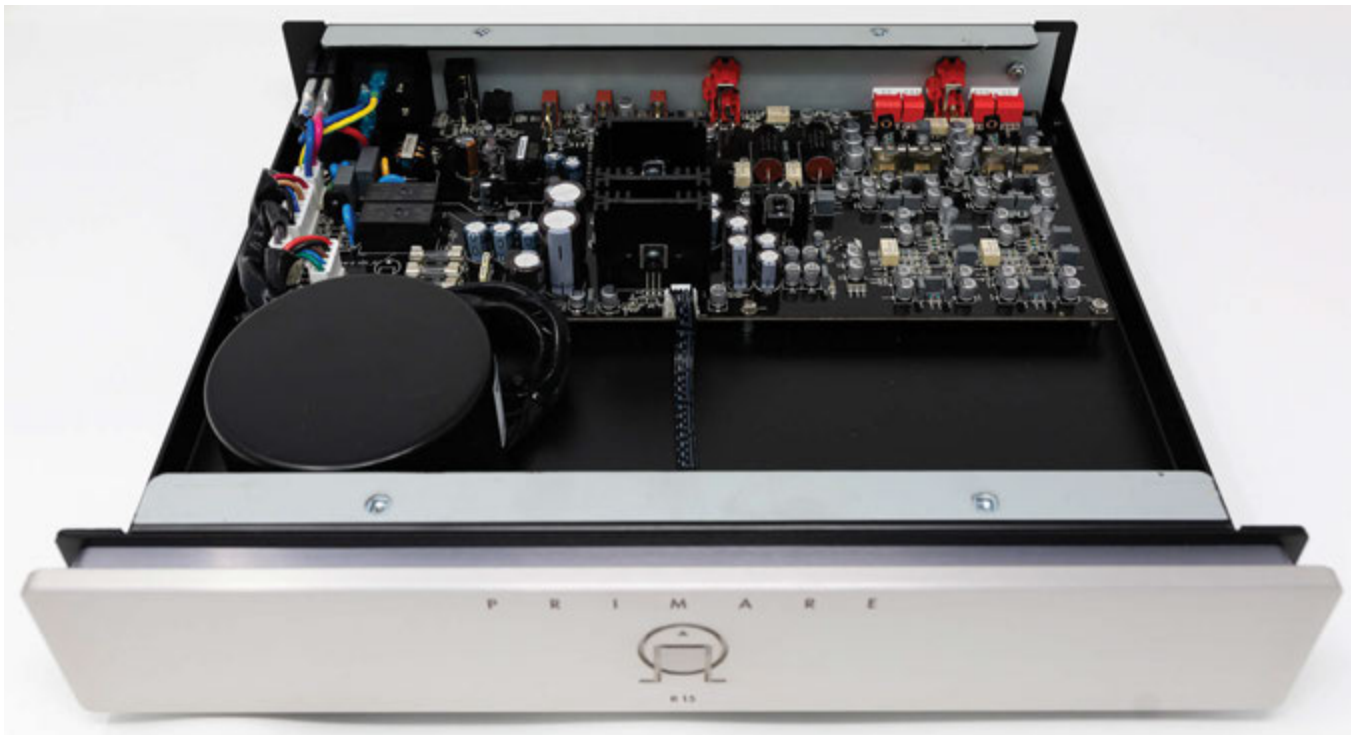
Figura 1 - La costruzione è molto ordinata e quasi priva di cablaggio. Notare il grande trasformatore toroidale di alimentazione.
