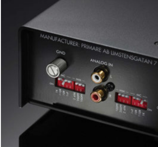
Figura 3 - Dettaglio relativo ai banchi di DIP switch per la regolazione del carico elettrico.
