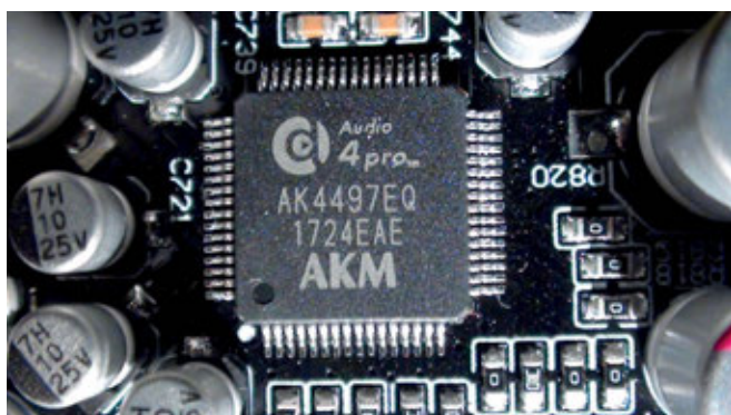
Per la conversione D/A è stato scelto l'ottimo convertitore Asahi Kasei AK4497EQ con architettura a 32 bit e tecnologia Velvet Sound.
