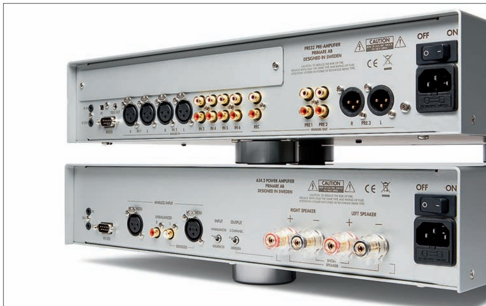
Symetryczne połączenia sygnałowe uzasadnia konstrukcja toru sygnałowego w przedwzmacniaczu. PRE32 ma aż trzy pary wyjść
