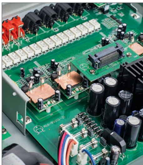
PRE32: pod miedzianymi radiatorami ukryto autorskie moduły wzmocnienia, po dwa na kanał (tor zbalansowany)
